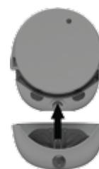
4. Vuelva a colocar la tapa de la batería. Gire el tornillo de bloqueo hacia la derecha para bloquear.
