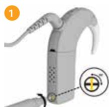
Gire el tornillo de bloqueo en sentido antihorario para desbloquear la tapa de la batería
