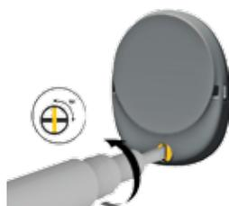
1. Gire el tornillo de bloqueo en sentido antihorario para desbloquear la tapa de la batería (en el sentido de las agujas del reloj para bloquear).
